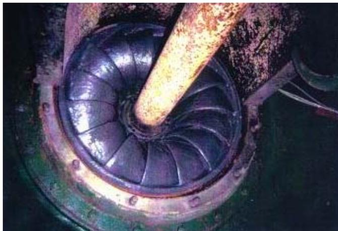
Instandsetzung von zwei Turbinenlaufrädern. Die Schadensstellen befanden sich an der Wasseraustrittsseite sämtlicher Schaufeln. Größere Löcher wurden zunächst zugeschweißt. Dann wurden die Auswaschungen mit Ceramium, pastös aufgefüllt. Als Kavitationsschutz wurde zuletzt eine Beschichtung des gesamten Bauteils mit VP 10-017 vorgenommen.
