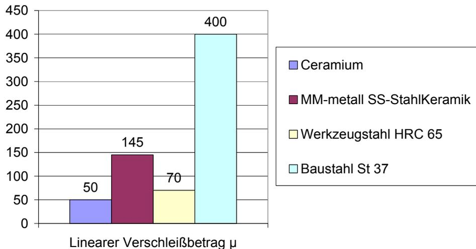
Die bei den Tests auftretende Art der tribologischen Beanspruchung entspricht dem Korngleitverschleiß in Anlehnung an DIN 50320.
