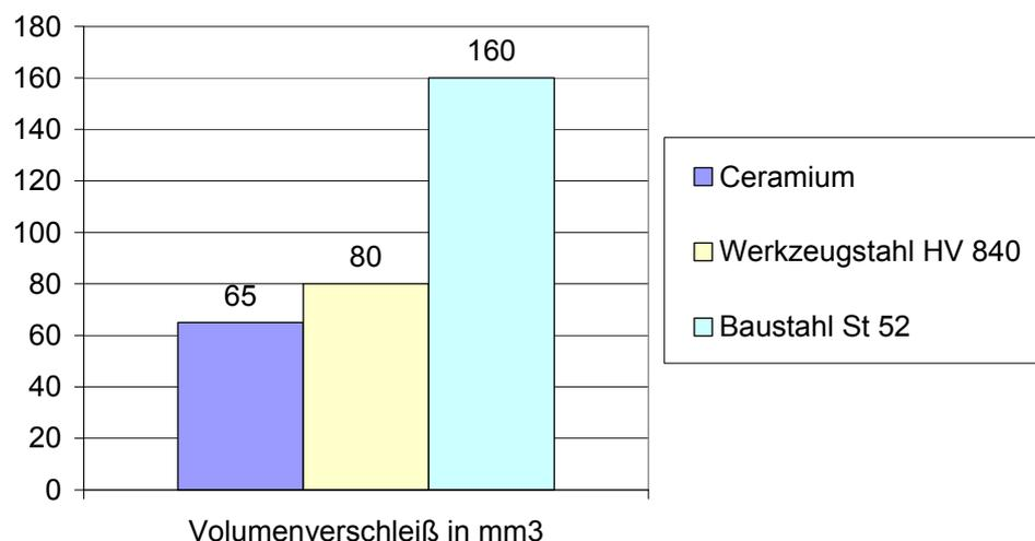
Die bei den Tests auftretende Art der tribologischen Beanspruchung entspricht dem Spülverschleiß (Erosionsverschleiß) in Anlehnung an DIN 50320.
